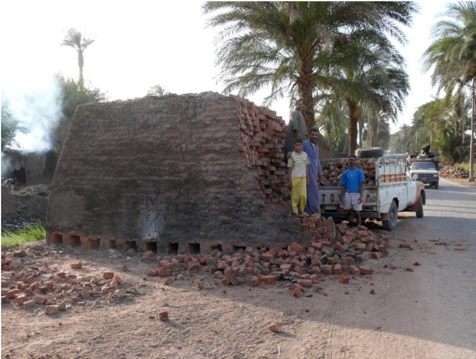
Abb. 1.25: Ziegelbrennerei im Gouvernorat Minia, 2010. Die mit Modeln geformten Ziegel werden zu regelmäßigen Stapeln über einem Brennholzraster aufgeschichtet; dann werden die Außenseiten der Stapeln mit Ziegelmasse verstrichen, bevor das Holz in Brand gesteckt wird. Bis zu drei Generationen arbeiten zusammen (Foto: U. Fauerbach).
