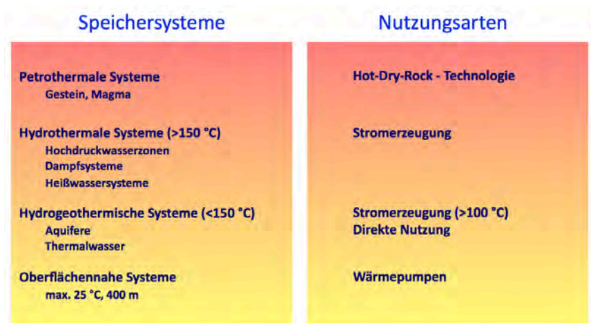
Abbildung 3.4: Überblick über die verschiedenen geothermischen Speichersysteme (Lagerstätten) und ihre Nutzungsarten.
